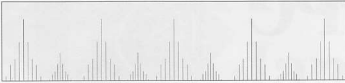
Figuur 7: Detail van een kleuren TV-sigitaal in het spectrum.
